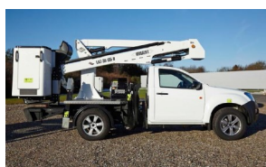
Brazo articulado inferior y 2 etapas pluma superior telescópica
