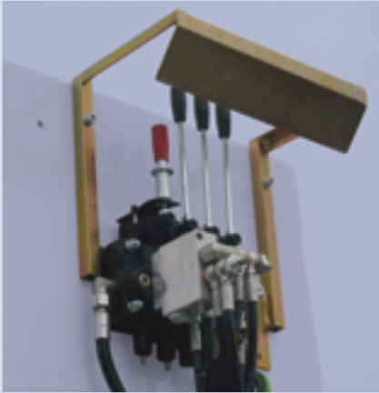
5 Carter e comandi sopra cestello Sumps and high controls on cage Carter et commandes sur panier Abdeckung und Steuerung am Arbeitskorb Carter y comandos arriba de la cesta Bedieningskast in de basket
