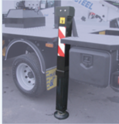
6 Stabilizzatori in sagoma Stabilizers in size Stabilisateurs dans le gabarit Estabilizadores dentro el perimetro Stutzen innerhalb Profil Afstempeling binnen opbouw
