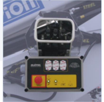
7 Carter e comandi di emergenza in basso Sumps and low emergency controls Carter et commandes d'urgence en bas Gehäuse und Notsteuerungen unten Carter y comandos de emergencia en la parte inferior Noodbediening beneden
