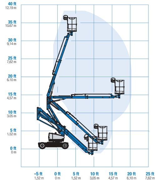
\* En el sistema métrico, altura de trabajo = altura de la plataforma + 2 m.
