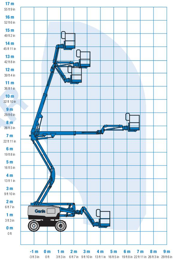
\* En el sistema métrico, altura de trabajo = altura de la plataforma + 2 m.
