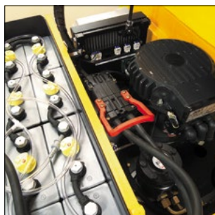
Motor de marcha y de elevación con tecnología de corriente trifásica
