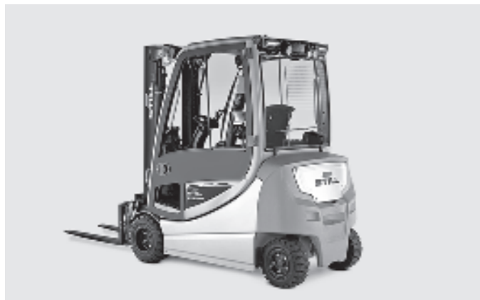
Versión de cuatro ruedas con cabina del conductor totalmente cerrada para uso en exteriores
