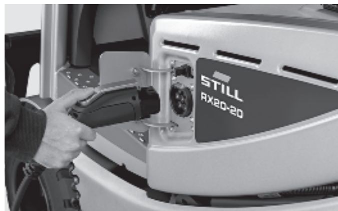
Cargador incorporado opcional para descentralizar la carga sin cambio de batería
