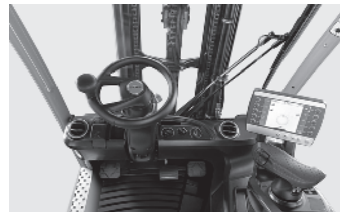
Espacio de trabajo con display y unidades de control, Joystick 4Plus y calefacción
