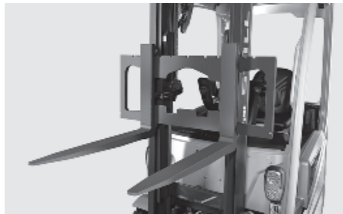
Vista óptima de las puntas de las horquillas al cargar camiones
