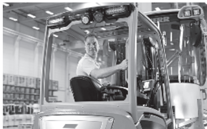
Asidero trasero con bocina opcional para una marcha atrás ergonómica y segura
