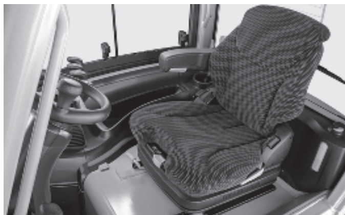
Asiento amplio con recubrimiento de tela y reposabrazos derecho
