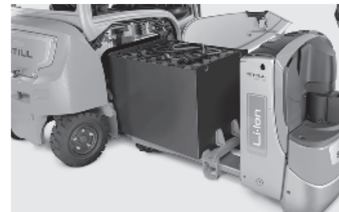
Cambio de batería con transpaleta eléctrica
