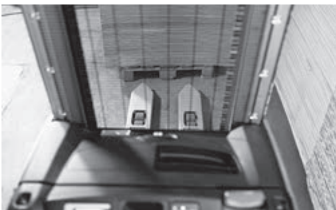
Los mástiles de visión libre de STILL aseguran en todo momento la mejor visibilidad de la punta de las horquillas
