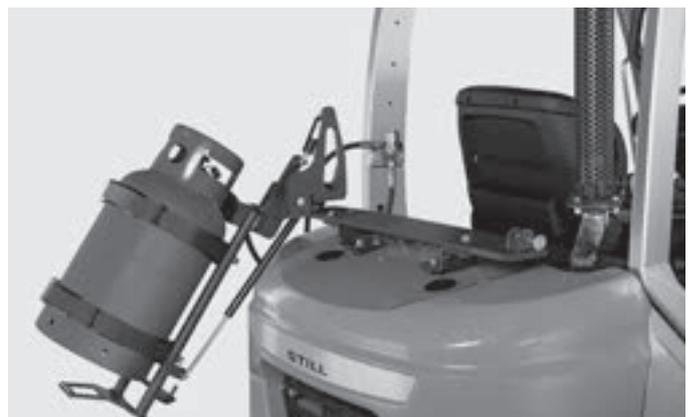
Cambiar las bombonas de gas ahora es más fácil y rápido gracias al portabombonas ergonómico con mecanismo de giro y plegado, en posición de "cambio aquí"
