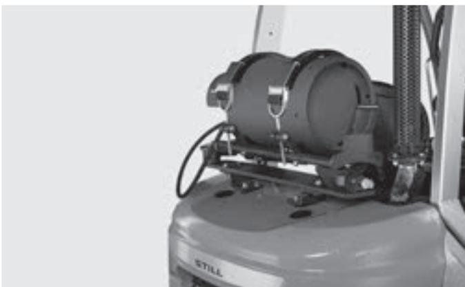
Cambiar las bombonas de gas ahora es más fácil y rápido gracias al portabombonas ergonómico con mecanismo de giro y plegado, en posición normal de "trabajo aquí"
